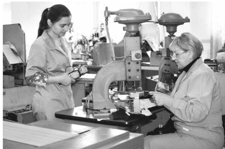
производительность труда. Сначала оборудование было подготовлено для заготовочных потоков «Парижской коммуны». В момент внедрения мы сами (технологи) вместе с механиками определяли, как устанавливать оснастку, чтобы каждой работнице было удобно и безопасно трудиться. Для каждой модели с разными видами подкладки мы индивидуально подбираем режим выдержки и температуру пластин. Татьяна Николаевна Иванова – для мужской и женской обуви, я – для детской. С использованием новой
