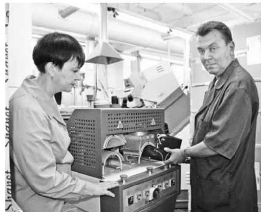
Все вновь приобретенные активаторы для увлажнения и разогрева заготовок перед затяжкой носочной части были опробованы в пошивочном цехе № 5 «Парижской коммуны».
