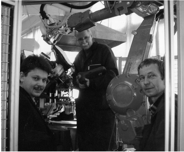
Юрий Германович МОРЕХОДОВ на Донской фабрике вместе с инженером-электроником Русланом Александровичем ШЕСТАКОВЫМ и механиком Виктором Ивановичем МОРДОВИНЫМ готовят к запуску робот для взъерошивания подошв.
